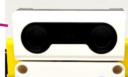
El sensor ultrasónico se parece a unos ojos y puede automatizar el movimiento.
